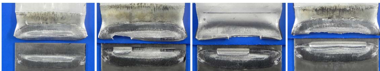
Abbildung 4: Versagensvarianten von vollständiger Trennung der Bleche (Links) in der Fügeebene, ausgerissene Teilanhaftungen Aluminium-Flyer am Stahl-Target (Mitte) und vollständiges Anhaften mit Versagen im Aluminium-Flyer
