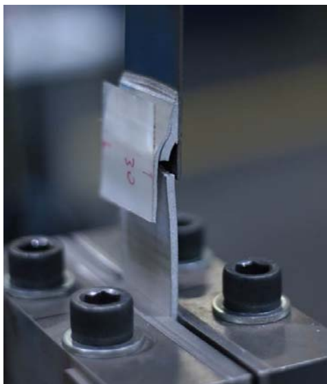
Abbildung 2: Prüfaufbau für die Schwingfestigkeitsversuche. Versagen der Aluminium-Stahl Proben im Grundwerkstoff
