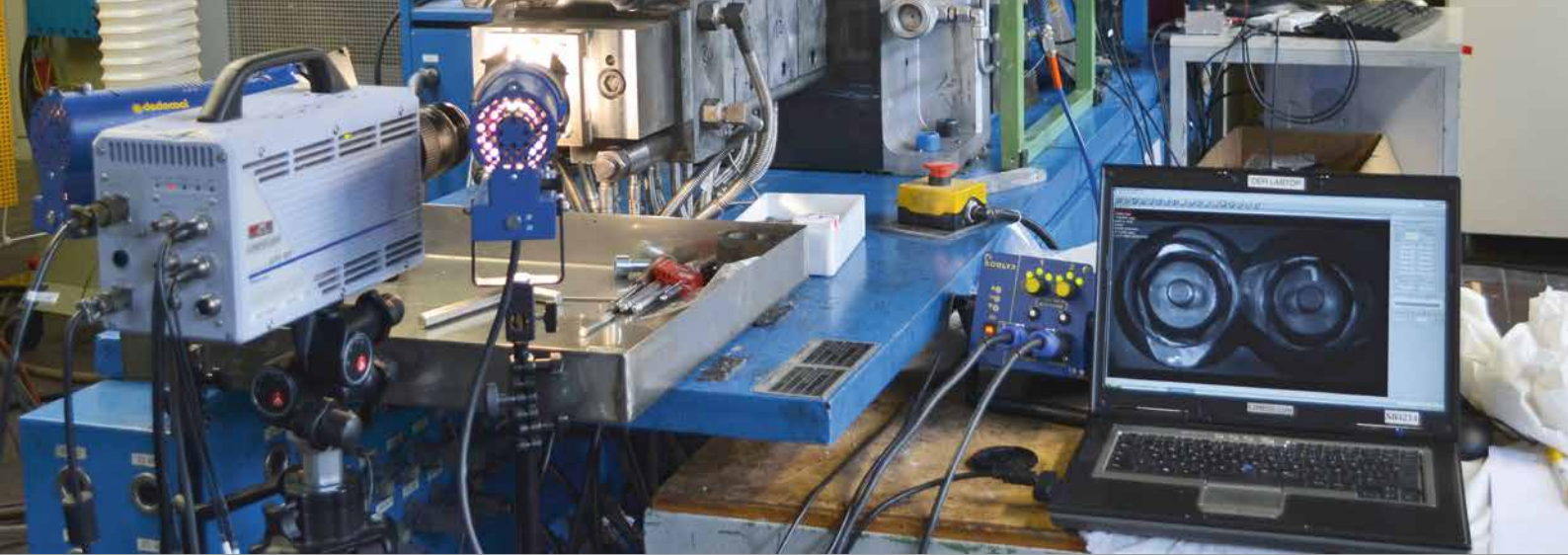
Abb.2: Versuchsaufbau zur Visualisierung der plastischen Deformation von Kunststoffgranulat in der Aufschmelzzone gleichläufiger Doppelschneckenextruder.
