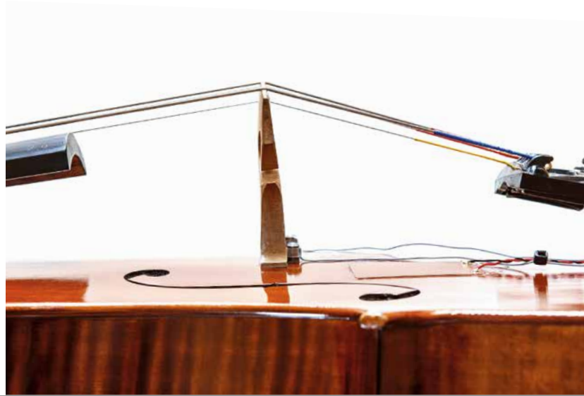
Seitenansicht des Cellos mit Sensoren und piezokeramischem Patch-Aktor. Side view of the cello with sensors and the piezoceramic patch actuator.
