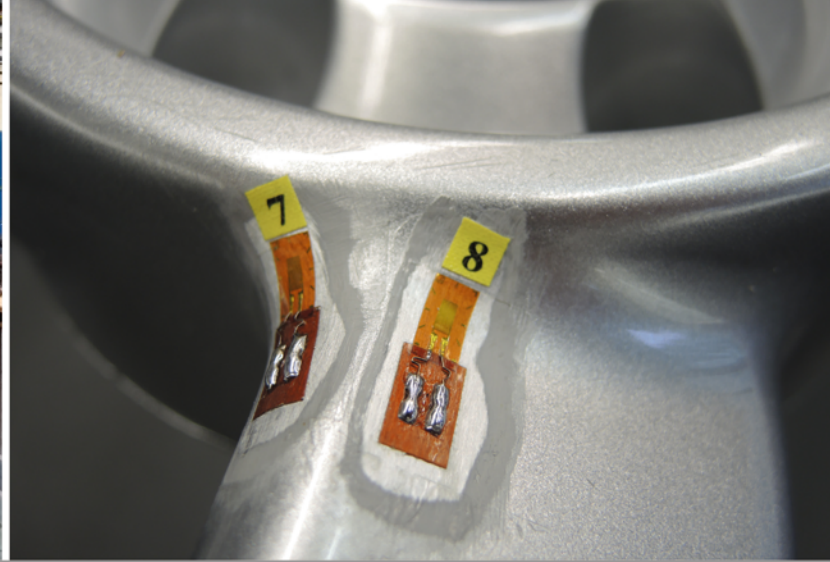
Dehnmessstreifen auf der LBF Felge zur verbesserten Kühlluftführung. Strain gauge on the LBF rim which ensures improved cooling air flow.
