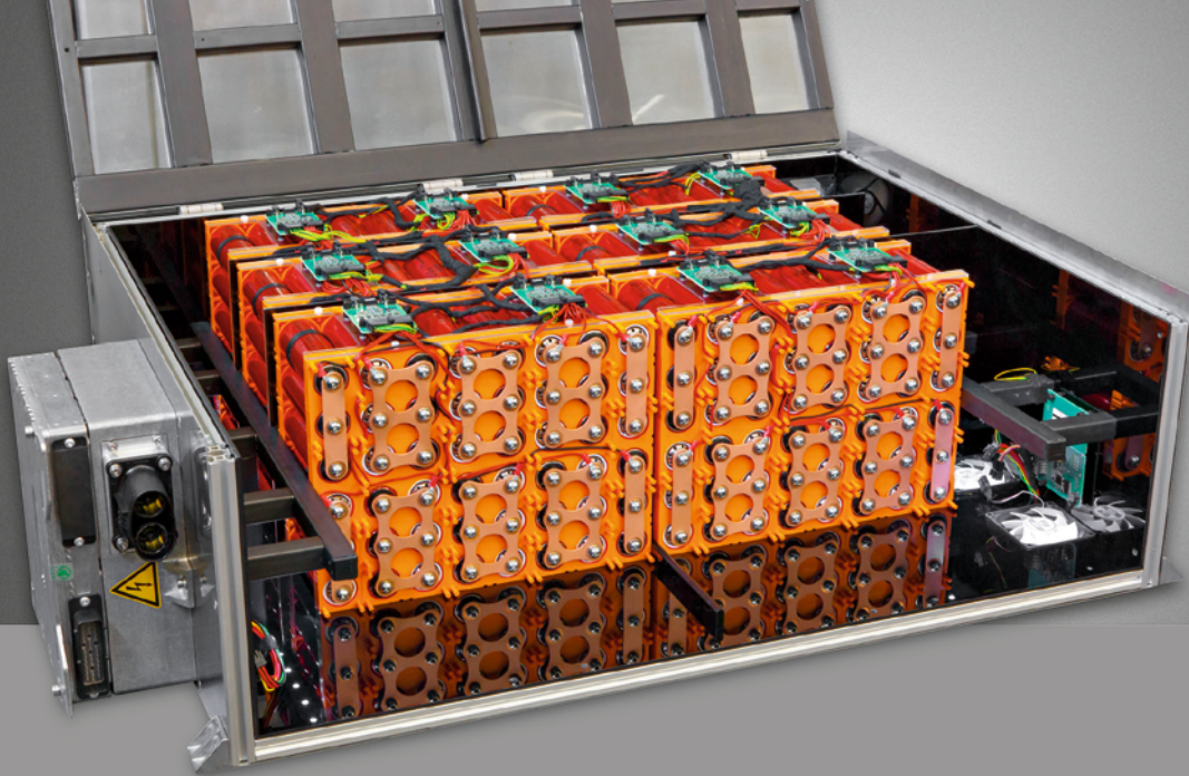
Abb. 2: Für Referenzversuche wurde im Fraunhofer LBF ein 10 kWh Batteriesystem mit eigensicheren LFP-Zellen sowie integriertem Batterie-Managementsystem entwickelt und aufgebaut. Fig. 2: At the Fraunhofer LBF, a 10 kWh battery system with intrinsically safe LFP cells and an integrated battery management system has been developed and constructed for reference tests.
