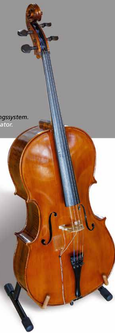
Seitenansicht des Cellos mit Sensoren und piezokeramischem Patch-Aktor. Side view of the cello with sensors and the piezoceramic patch actuator.
