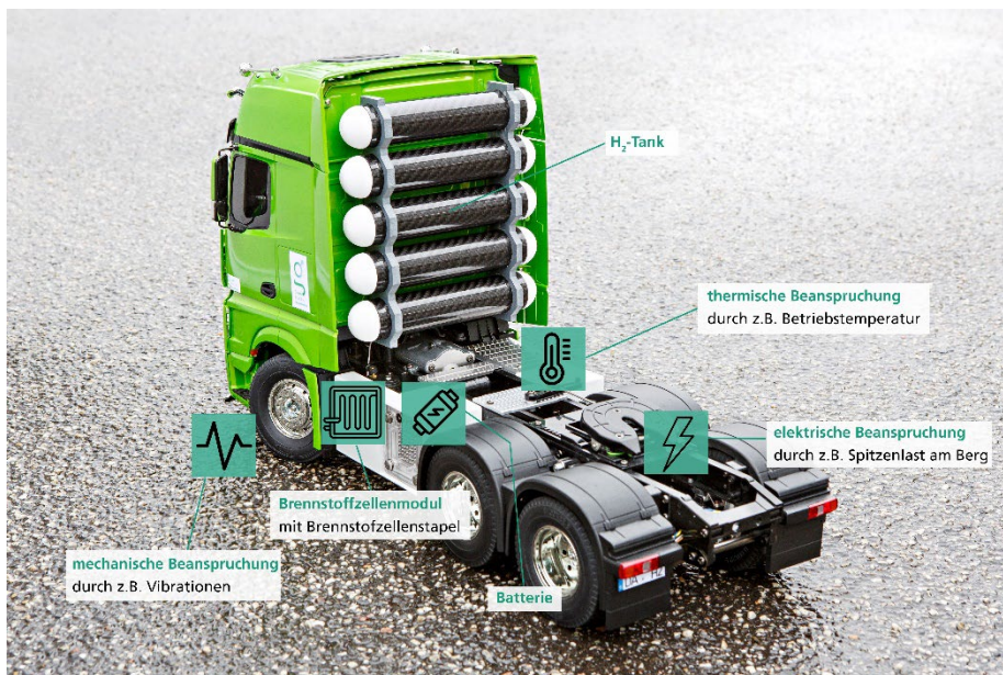
Fraunhofer-Forschende bewerten in »multiPEM« die Systemzuverlässigkeit von Brennstoffzellen-Stapeln unter multiphysikalisch-chemischer Beanspruchung in Nutzfahrzeugen. Grafik: Fraunhofer LBF
